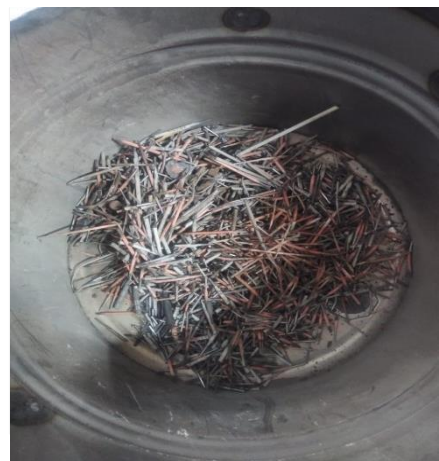
Cambio de colillas de Soldadura usadas por Nuevas
